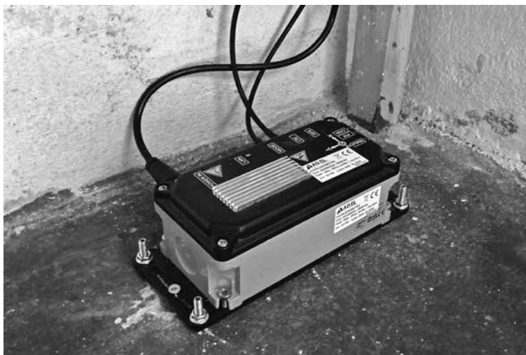
V BREGINJU JE NAMEŠČENA NOVA NAPRAVA ZA MERJENJE POTRESOV , ki bo v okviru projekta Concordia prispevala k natančnejšemu spremljanju potresne dejavnosti in večji varnosti prebivalcev.
