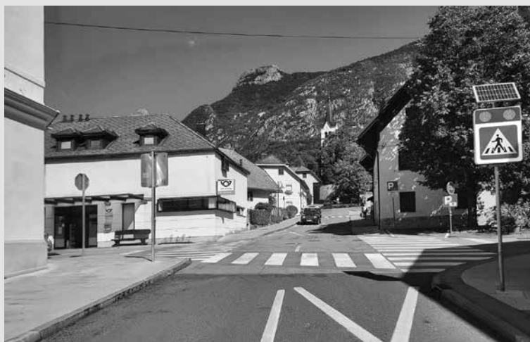
V BOVCU SO OB OSNOVNI ŠOLI NAMESTILI INTELIGENTNI PROMETNI SISTEM COPS@zebra LITE ZA VEČJO VARNOST PEŠCEV , ki voznike opozarja na prehod za pešce in spodbuja umirjanje prometa.
